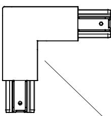
Sfondare la pre-rottura per il passaggio del cavo, collegare i conduttori facendo attenzione alla dicitura + – e successivamente bloccati tramite il ponticello fermacavo.
